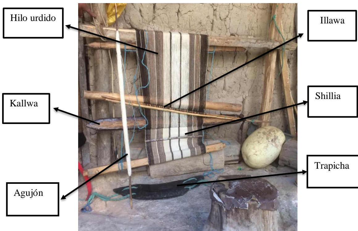
Figura 8. Comunidad de Oñacpac. Partes del telar a la cintura. Fuente: Karina M. Guallpa R. y Ximena A. Guallpa R.
